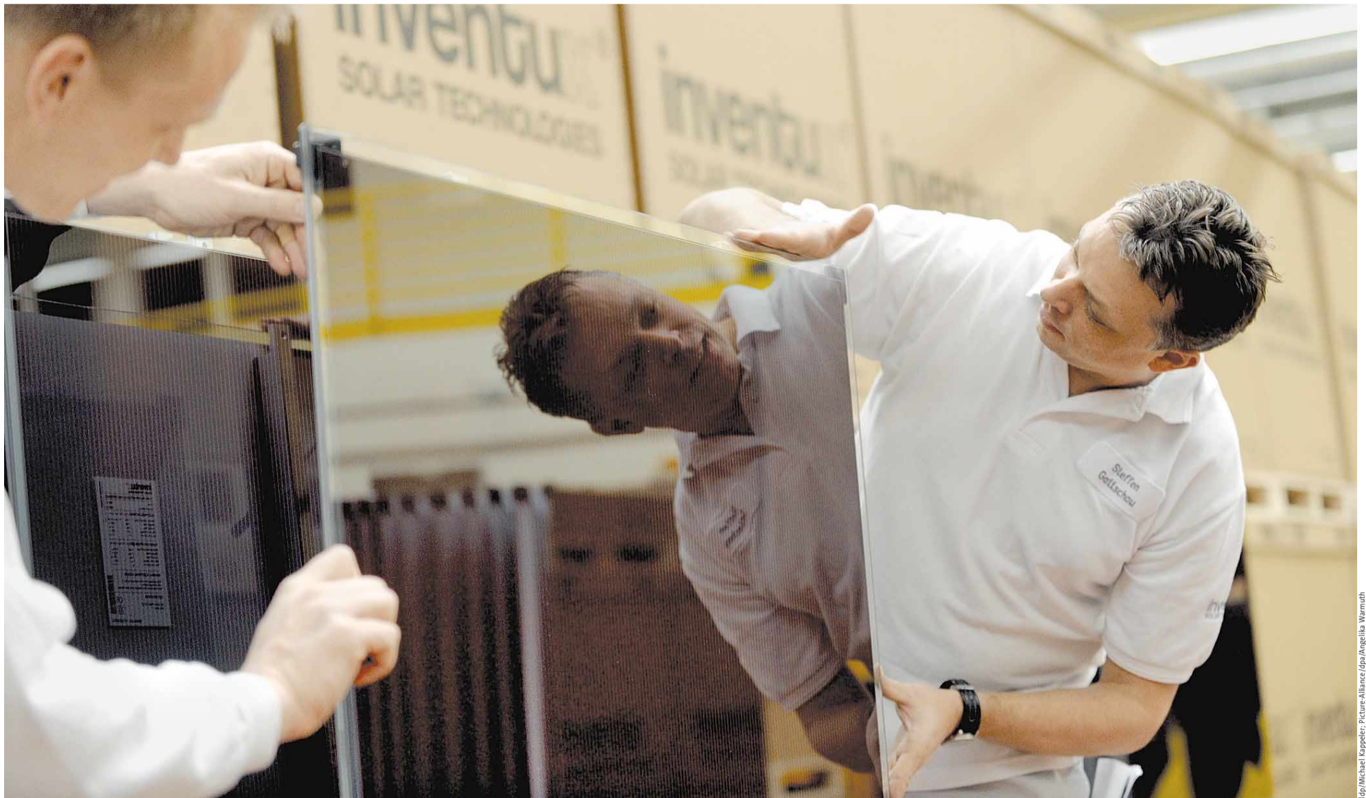
Mitarbeiter des Solarzellenherstellers Inventux prüfen die Oberfläche eines Solar-Dünnschichtmoduls in Berlin-Marzahn
